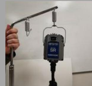
3. Accrochez le moteur au support à moteur (vous pouvez utiliser des attaches-câble (tie-wrap) pour fixer le fil au support).
