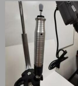
6. Lorsque vous ne l'utilisez pas, insérez l'outil à main dans le double support fixé au support à moteur.
