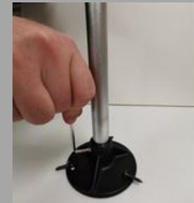
3. Au moyen de la clé Allen fournie dans la boîte, vissez le tuyau en place.
